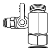
Válvula en T para suministro de agua con arandela de goma (conexión de 3/8")
